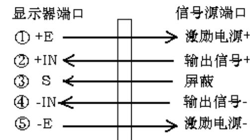
图 (二) 传感器与五芯航空针连线图
